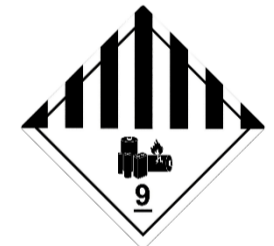
Etiqueta 9a Baterías de litio
